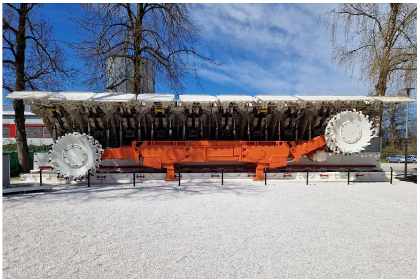
11. aprila letos smo v parku Muzeja premogovništva Slovenije postavili največji razstveni eksponat, ki ga sestavljajo hidravlično podporje, sestavljeno iz 10 sekcij, ter pridobivalni stroj in verižni odkopni transporter. Širina prikazanega dela odkopa je 18 metrov, višina do 4,7 m. (foto: Slobodan Mrkonjić)
